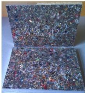
Zdjęcie 1. Próbką do badań według PN-EN 717-1:2006
