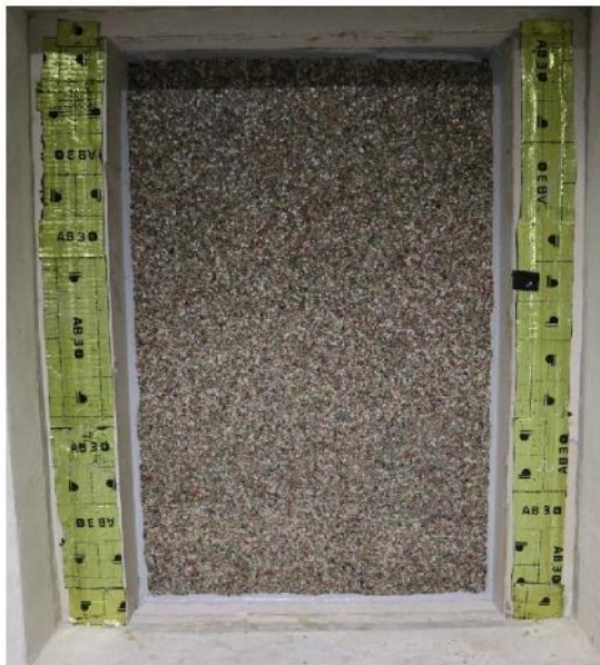
Fotografia 1 Badany element od strony komory nadawczej.
