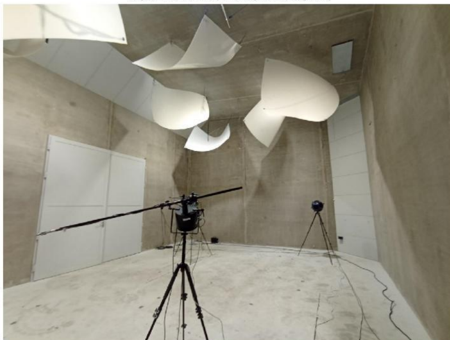
Fotografia 2 Rozmieszczenie pochłaniaczy w komorze pogłosowej
